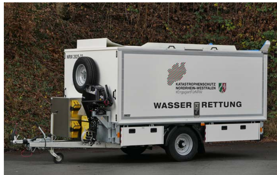
Geräteanhänger für die Wasserrettung. Bildnachweis: © Ewers Karosserie- und Fahrzeugbau
