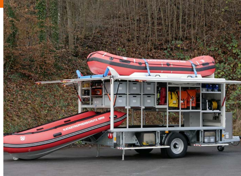
Sämtliche für den Einsatz erforderlichen Materialien der Strömungsretter finden sich auf den neuen Geräteanhängern. Bildnachweis: © Ewers Karosserie- und Fahrzeugbau
