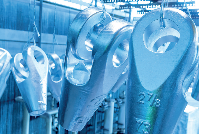
Sockets nach dem Verzinkungsprozess in Hagen.
