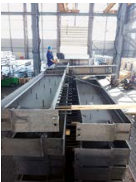
Bauteile, die einer Doppeltauchung im Zinkbad bedurften.
