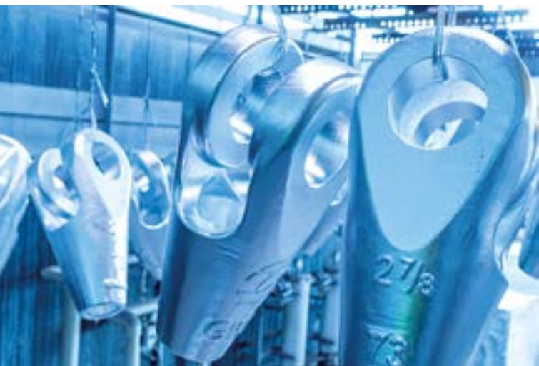
Sockets nach dem Verzinkungsprozess in Hagen.
