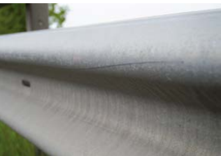
Abb. 3: Dünnschicht-„microZINQ“-verzinkte Schutzplanke mit Anfahrspur.
