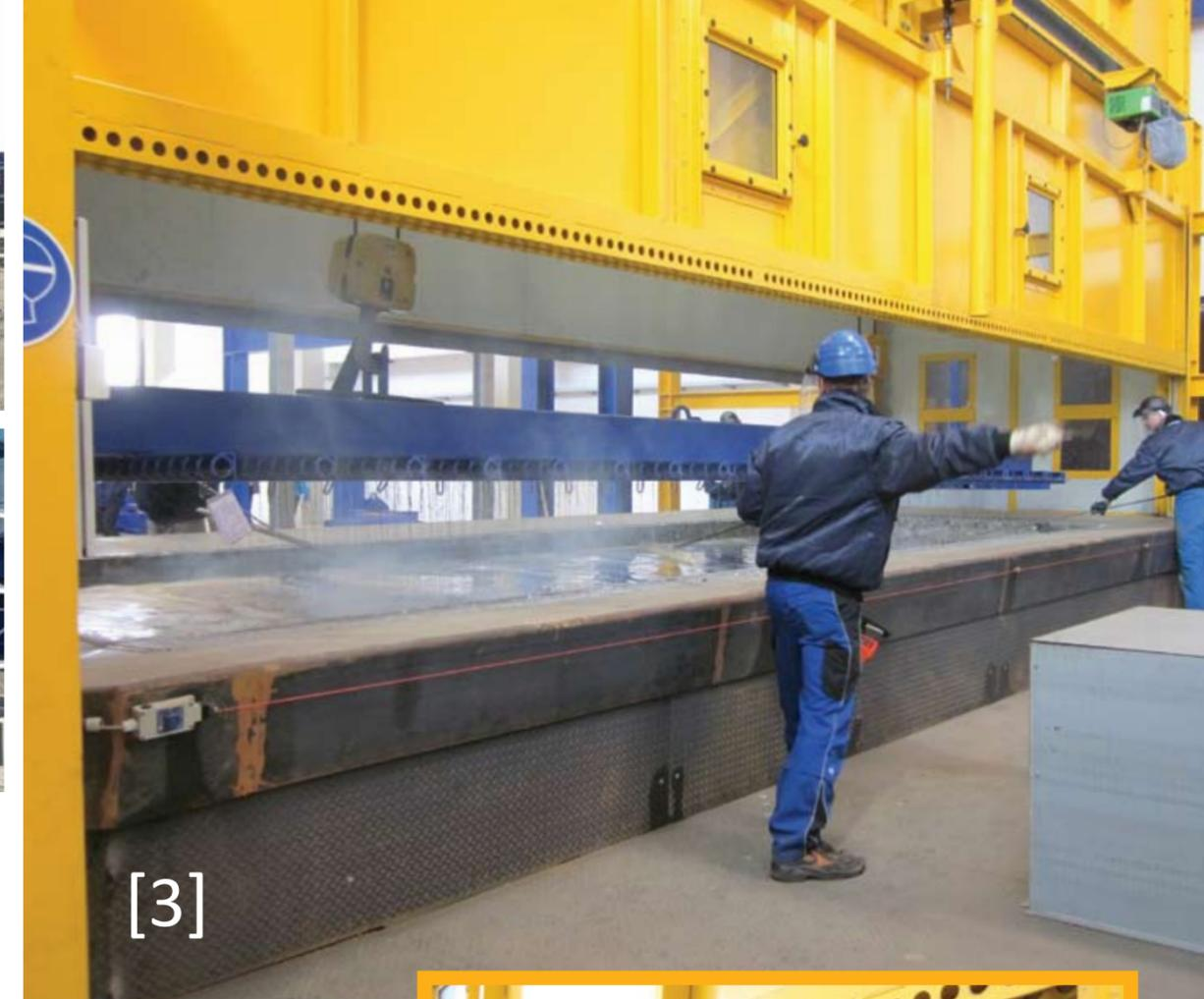
Maintal: [3], [4] Verzinkung eines Behälters von 2,50 Meter Breite
