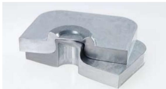
Mit **microZINQ®** beschichtete Materialprobe, punktuell nach der Beschichtung verformt (Fügeverfahren Clinchen)
