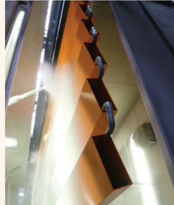
Die Applikation hochwertiger Pulverlacke direkt nach dem Feuerverzinken in integrierten Prozessen ist eine ideale Möglichkeit, individuelle Ästhetik mit nachhaltig wirksamem Korrosionsschutz zu kombinieren. Voigt & Schweitzer bündelt diese Art der Oberflächenveredelung in seiner Produktmarke colorZINQ®, der folgende Prozesse zugrunde liegen:
