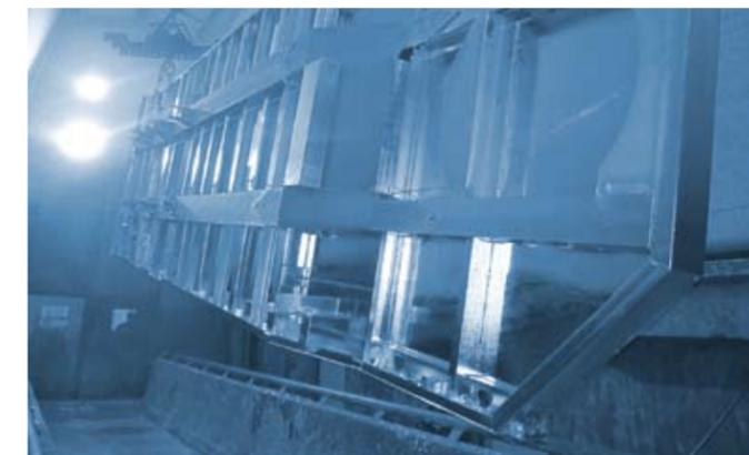
Genau diesen offenen und konstruktiven Dialog pflegen Fliegl und Voigt & Schweitzer seit nunmehr 16 Jahren. Verschweißte Rahmen für den Bau von Trailern sowie zahlreiche weitere Fahrzeugbauteile werden durch Voigt & Schweitzer vom Fliegl-Werk in Triptis (Thüringen) abgeholt, mit bestmöglichem duroZINQ® Korrosionsschutz für den robusten Einsatz versehen und anschließend wieder an den Fliegl-Stammsitz nach Triptis geliefert.
