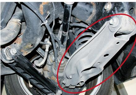
**Abb. 1: Unterfahrwerkskomponente (Sturzenlenker) mit einer microZINQ®-Beschichtung nach 200 000 km Fahrleistung**
