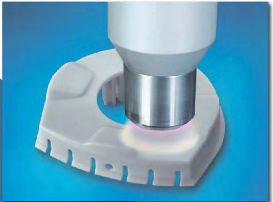
Hocheffektive Oberflächenaktivierung durch eine Behandlung mit Atmosphärendruckplasma (Bild: Plasmatrete GmbH)
