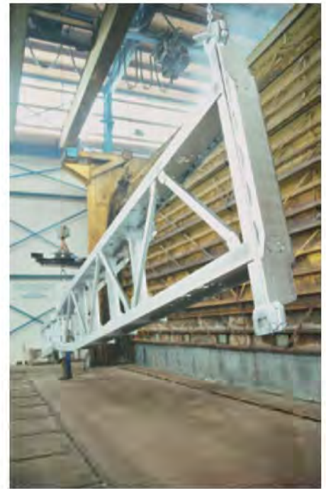
Abb. 2: Richtiges Handling nach dem Verzinkungsprozess zur Vermeidung von Verzug
