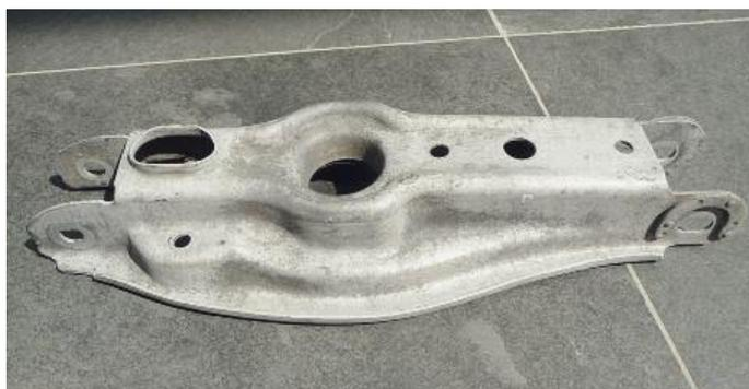
Bild 2: Mit microZINQ® verzinktes Unterboden-teil (Fahrwerk) nach sechs Jahren (gereinigt)
