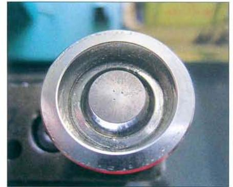
Clinchpunkt an einer microZinc-beschichteten Probe (links und Mitte), Zustand der Matrice (rechts)
