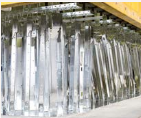
Langsam zieht der Kran die schweren Träger aus dem 450 Grad heißen Zinkbad
