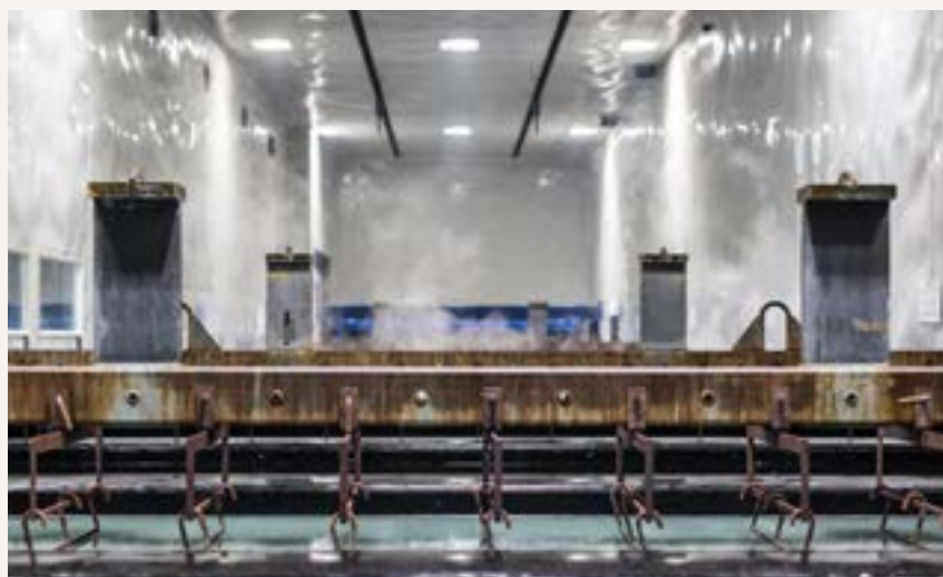
In mehreren Stufen werden die rohen Metallteile mittels Säuren, Laugen und Zwischenbädern vorbehandelt, bevor der eigentliche Zinküberzug auf das Metallbauteil trifft
