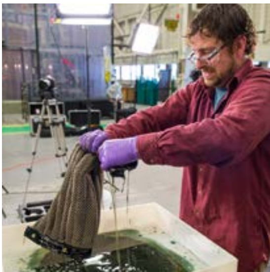
Durch einfaches Auswringen gibt der Oleo Sponge das aufgesogene Öl wieder ab und kann somit vielfach wiederverwendet werden
