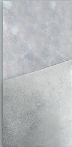
Nicht passiviertes / passiviertes Musterblech: links im Nullzustand, rechts nach 4 Wochen.
