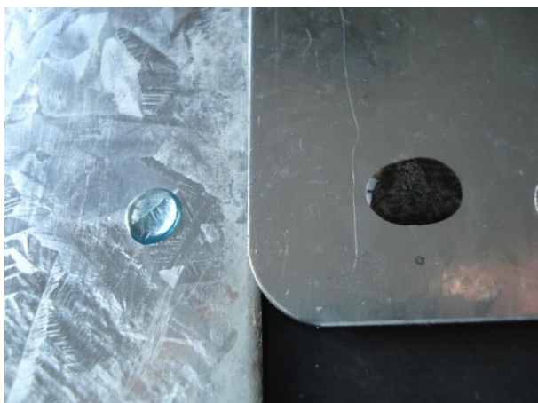
Kopersulfaat test (links: niet goed/rechts: goed)
