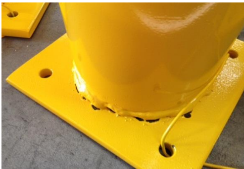
Une sortie de graisse entraîne des manques
