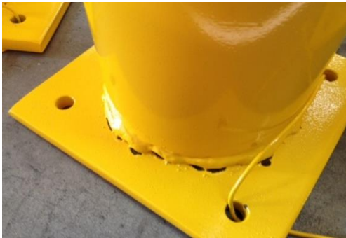
Austretendes Fett führt zu Fehlstellen
