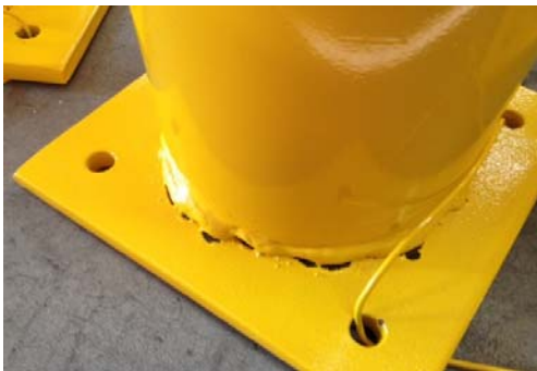
Austretendes Fett führt zu Fehlstellen
