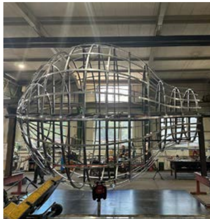
Blick in die Werkstatt von C. Heider Metallbau GbR beim (Probe-)Aufbau des „Innenlebens“ der Montgolfière in liegender Position. (© C. Heider Metallbau GbR)
