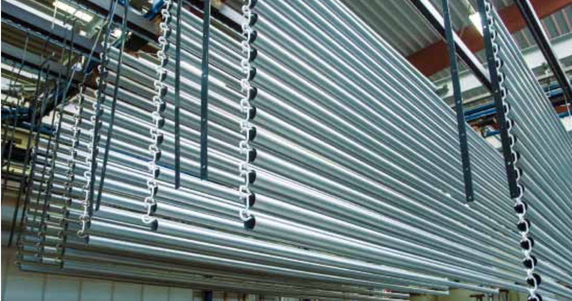
Markisenrohre an der automatischen Förderanlage.
