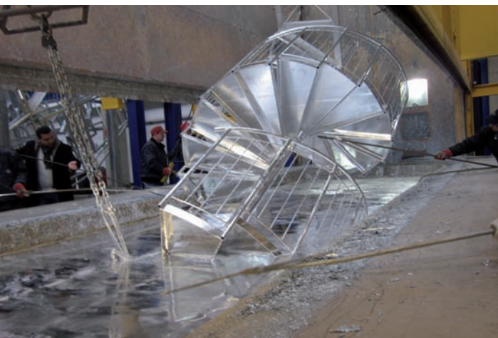
2,45 Meter Breite an einem Stück verzinken? ZINQ in Maintal macht es möglich.
