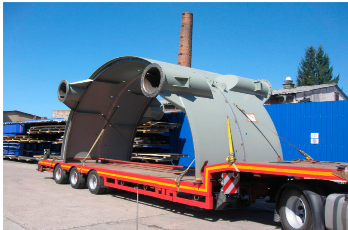
Geteilte Standzarge in Transportlage in Nordhausen. Diese wird auf der Baustelle zu einem runden Bauteil zusammengesetzt und mit dem Behälter verschweißt. An die Flansche, die seitlich zu sehen sind, werden dann die Fußrohre angeschraubt und nach dem Ausrichten werden diese an der zinkfreien Seite mit den Fundamentplatten verschweißt. (© Apparatebau Nordhausen GmbH)
