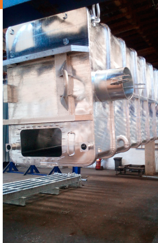
Optimales Ergebnis dank feuerverzinkungsgerechtem Konstruieren und Fertigen: Der Behälter nach dem Verzinkungsbad.
