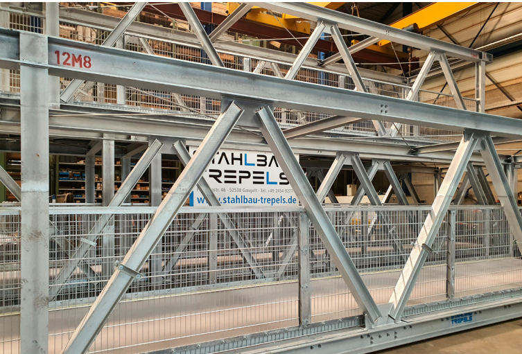
Die vormontierten Brückenelemente. (© Stahlbau Trepels)
