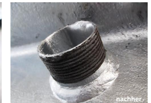
Außengewinde und Funktionsflächen werden mit **ZINQ<sup>®</sup> Free** bei der Feuerverzinkung zuverlässig frei von Zink gehalten.
