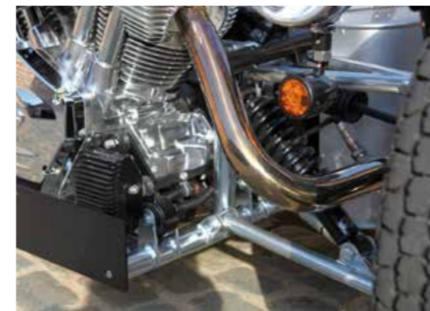
Dieser Morgan 3-Wheeler hat das, was kein anderer sonst hat: das erste mikroverzinkte Chassis der Welt und einen verzinkten Gitterrohrrahmen.
