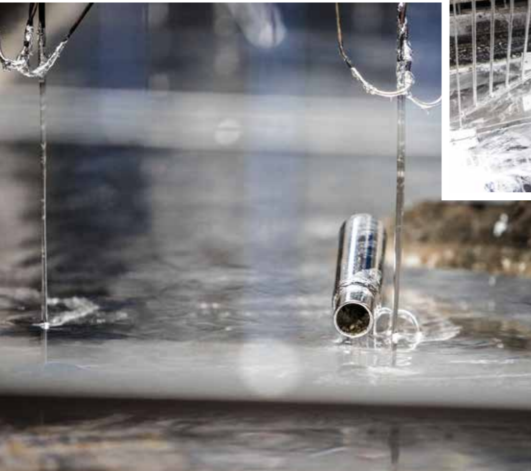
Tauchbad in duroZINQ® für Stalleinrichtungen.
