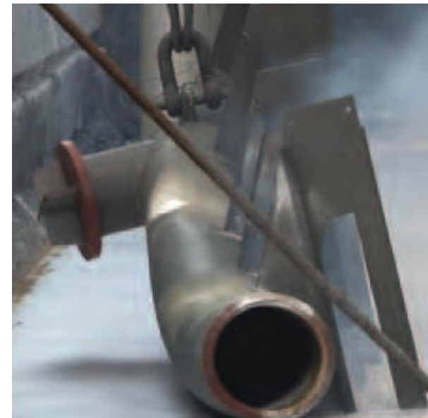
Das Material darf beim Eintauchen in das 450° Celsius heiße Zinkbad nicht „tanzen“ und muss so vorsichtig geschwenkt werden, dass innen und außen 100 % Korrosionsschutz erreicht werden.
