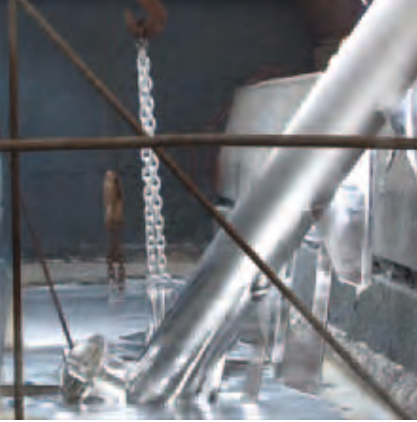
Das Zinkbad beinhaltet bei einer Abmessung von 1,80 Meter Breite x 3,20 Meter Tiefe x 17,20 Meter Länge circa 650 Tonnen Zink.
