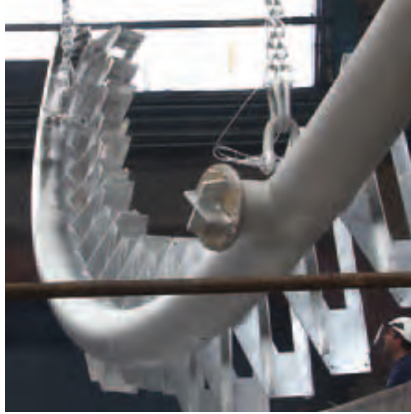
Beim Abkühlvorgang wird die Verzinkung grauer.
