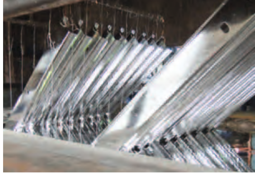
..... microZINQ® -Anlage in Hagen mit Querlenkern (links) und Unterfahrerschutz (rechts). Die komplett automatisierte microZINQ® -Anlage der Voigt & Schweitzer-Gruppe am Standort Hagen weist Badabmessungen von 4 Meter Länge x 2 Meter Breite x 3 Meter Tiefe auf und erlaubt Teilgewichte von maximal 1 Tonne.
