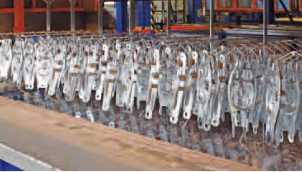
..... microZINQ® -Anlage in Hagen mit Querlenkern (links) und Unterfahrerschutz (rechts). Die komplett automatisierte microZINQ® -Anlage der Voigt & Schweitzer-Gruppe am Standort Hagen weist Badabmessungen von 4 Meter Länge x 2 Meter Breite x 3 Meter Tiefe auf und erlaubt Teilgewichte von maximal 1 Tonne.
