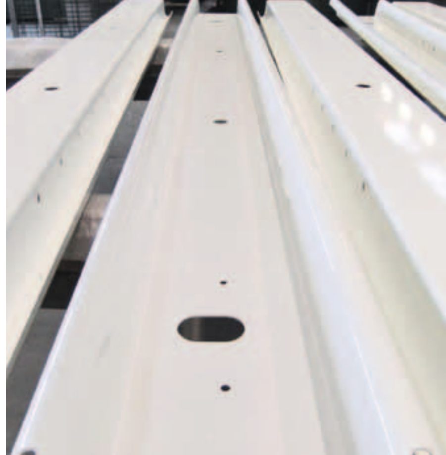
Unterfahrerschutz nach der Mikroverzinkung (links oben) Verzinkter und pulverbeschichteter Unterfahrerschutz (rechts oben)
