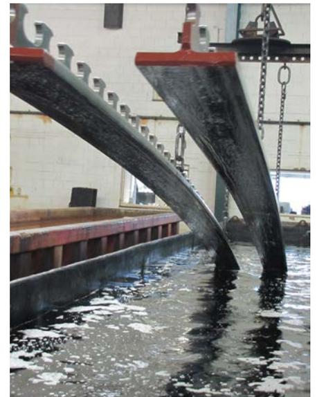
Bild 8. Beizen der Träger: Die Stelle des Baustellenstoßes ist mit Abdecklack maskiert
