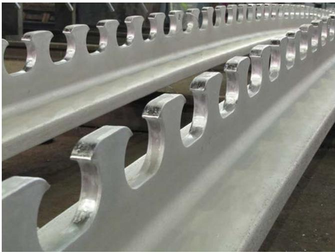
Bild 10. Verzinkte Träger beim Abkühlen
