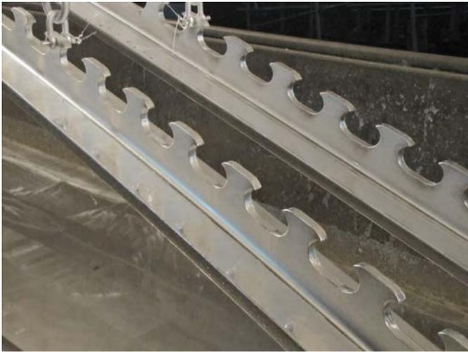
Bild 9. Verzinkung der Träger
