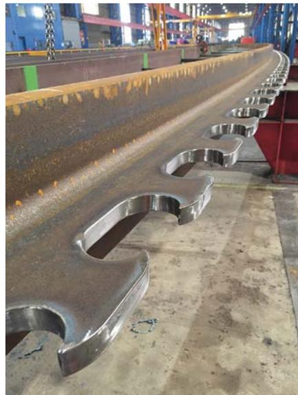
Bild 7. Detailaufnahme der Dübel am überhöhten Walzprofilträger
