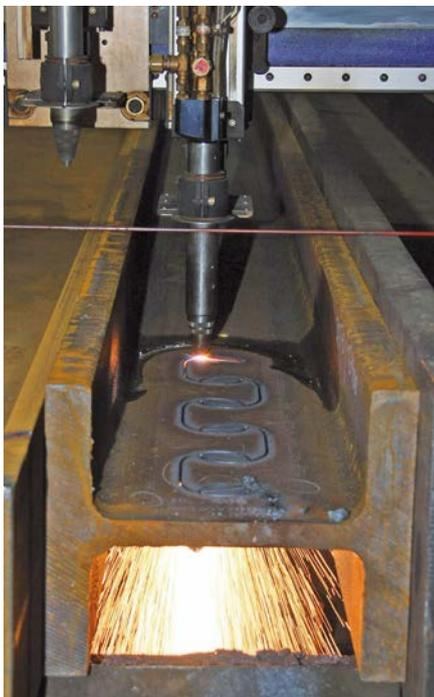
Bild 6. Schneiden des Walzprofils in zwei T-Profile mit Klothoidendübel
