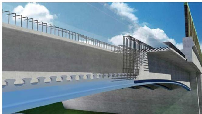
Bild 1. Visualisierung der Bauweise VFT-WIB aus Fertigteilträgern mit externer Bewehrung
