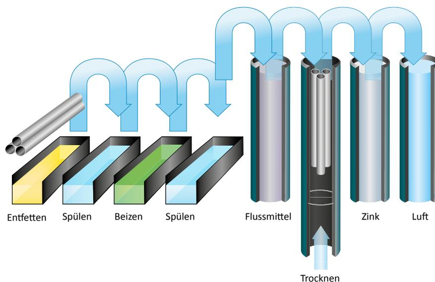
Das Rohr oder Profil wird senkrecht in ein 7,50 m tiefes Zinkbad getaucht. Mit diesem Verfahren werden wir den besonderen Qualitätsanforderungen gerecht, die in der Weiterverarbeitung von verzinkten Rohren und Profilen auftreten. Senkrecht ist besser.
